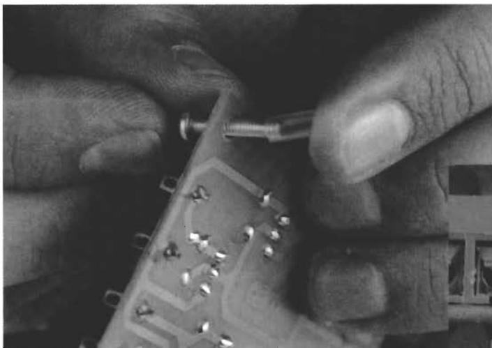
*Figura 3.7 Para ubicar la fuente sobre una base firme y segura se puede utilizar un chasis o pieza metálica sobre la que se fijan el circuito impreso y el transformador. Para esto se utilizan tornillos con tuerca y un separador plástico que permita separar la parte inferior de la plaqueta de la lámina metálica, esto con el fin de evitar posibles cortos. En la gráfica se aprecia el detalle de dicho montaje.*
