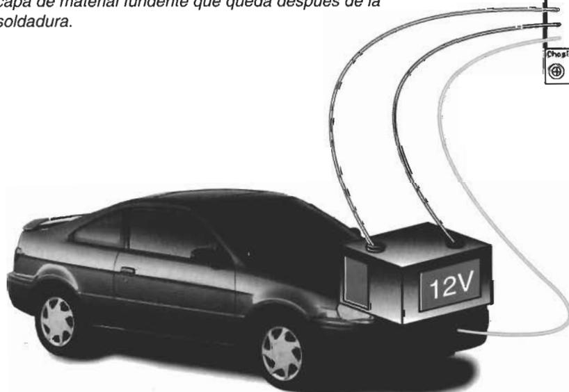
Figura 25.5 El monitor de batería puede ser utilizado en vehículos con batería de 12 ó de 24 voltios. En este último caso, se recomienda colocar un disipador de calor al regulador 7805. El circuito se puede dejar con unos cables de conexión largos y caimanes, de esta forma, se puede hacer la prueba rápidamente en diferentes vehículos.
