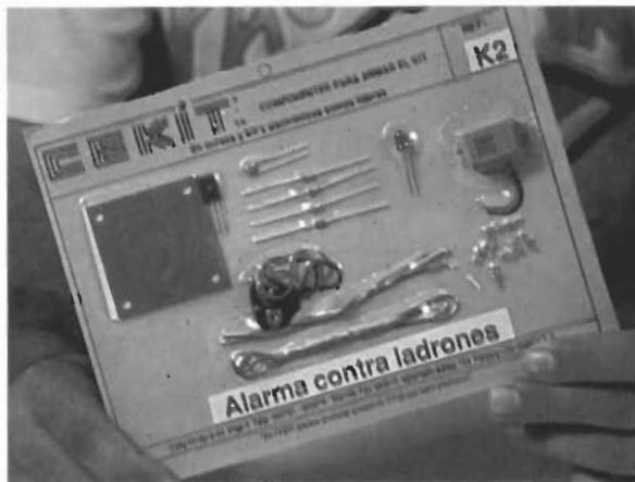
Figura 1.3 Todos los componentes necesarios para la construcción del proyecto, con excepción de los sensores y la caja de montaje, están incluidos en el kit K-002 de CEKIT (Alarma contra ladrones).
