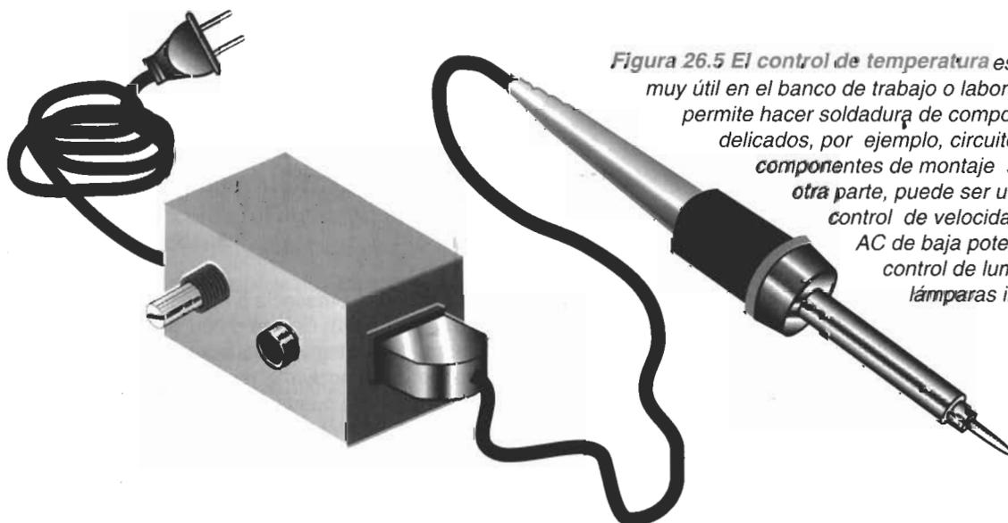
**Figura 26.5** El control de temperatura es un elemento muy útil en el banco de trabajo o laboratorio ya que permite hacer soldadura de componentes delicados, por ejemplo, circuitos integrados y componentes de montaje superficial. Por otra parte, puede ser utilizado como control de velocidad de motores AC de baja potencia o como control de luminosidad de lámparas incandescentes.
