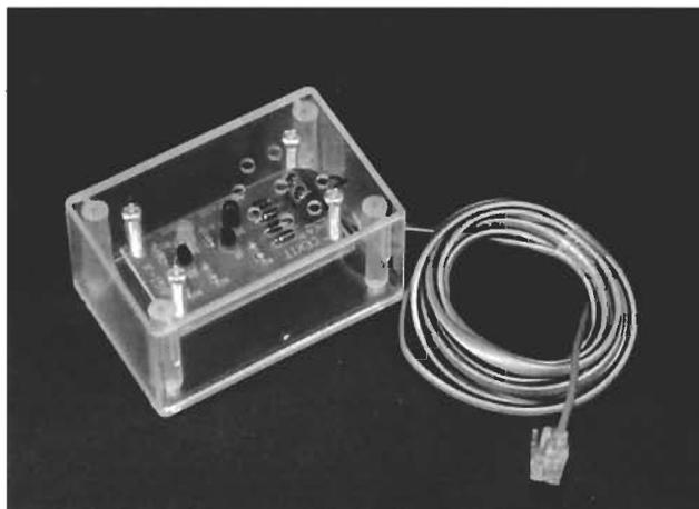
*Figura 11.5 El circuito terminado se debe instalar cerca del teléfono para que pueda ser visto fácilmente. Además, para protegerlo de posibles daños, se puede instalar dentro de una caja plástica o chasis. Obviamente, lo ideal es que todas las extensiones tengan su dispositivo indicador.*
