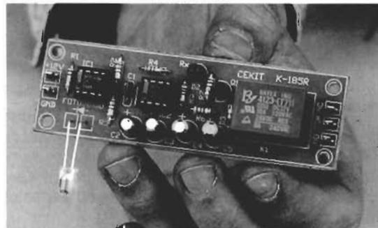
*Hay que poner mucha atención en el momento de instalar el LED infrarrojo y el fotodiodo para no confundir sus terminales y lógicamente, para no confundirlos a ellos ya que pueden llegar a tener la misma apariencia.*
