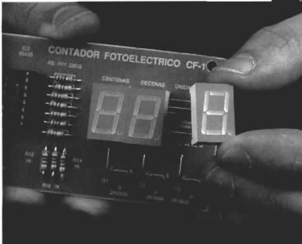
*Siga con la instalación de los displays, cuidando que el punto decimal quede localizado en la parte inferior derecha. Después, instale los circuitos integrados en sus bases, fijándose muy bien que el pin N° 1 quede correctamente orientado. Cuando esté listo el circuito, asegúrese de que todos los componentes están bien colocados, comparando su posición con la que les corresponde de acuerdo a la figura.*
