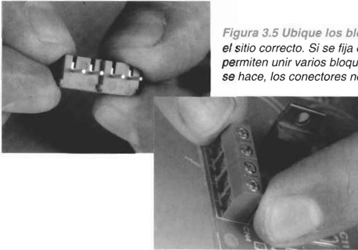
*Figura 3.5 Ubique los bloques de terminales y los espadines en el sitio correcto. Si se fija con detalle podrá ver las guías que permiten unir varios bloques para formar uno más grande, si esto no se hace, los conectores no quedan ubicados de forma correcta.*
